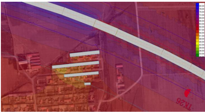
总屯二村中期昼间无措施
